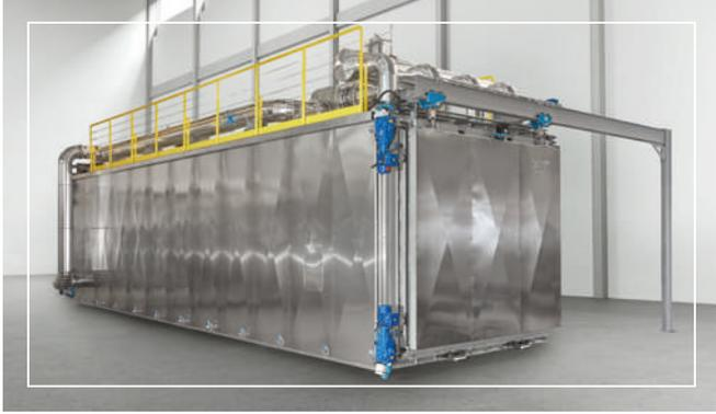
**Recirculation d'air:** Dans la partie supérieure de la chambre, un système performant de recirculation d'air assure une excellente distribution d'ETO et d'uniformité de température (+/- 1°C) pour faciliter la validation. C'est un procédé stable qui utilise une garniture mécanique de dernière génération.
