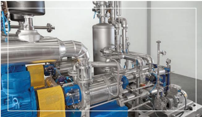
**Salle des gaz:** Classée comme ATEX zone 1, la salle des gaz doit être séparée de l'autoclave. Nous avons un design qui permet le changement automatique des containers ETO installés sur des balances.
